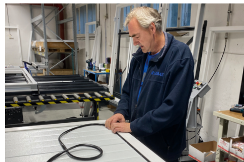
Montering av LOBAS® PORTEN ståldør.
